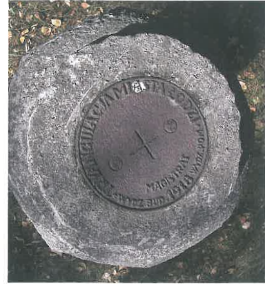
Znak podstawowej sieci triangulacyjnej na punkcie „W” – Wiatrak na Stokach.
