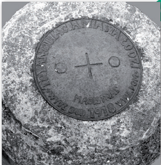
Jedyny, do dziś dobrze zachowany, znak podstawowej sieci triangulacyjnej na punkcie „W” – wiatrak na Stokach
