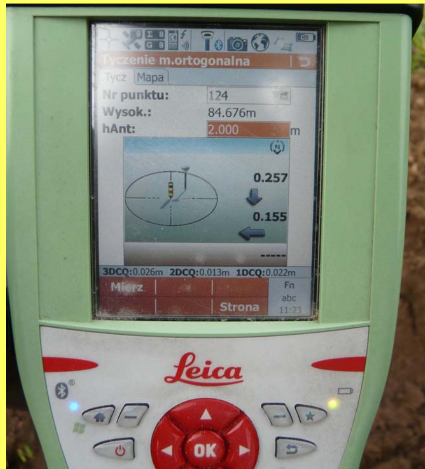
Rys. 15. Odszukany punkt osnowy nr 124k.
