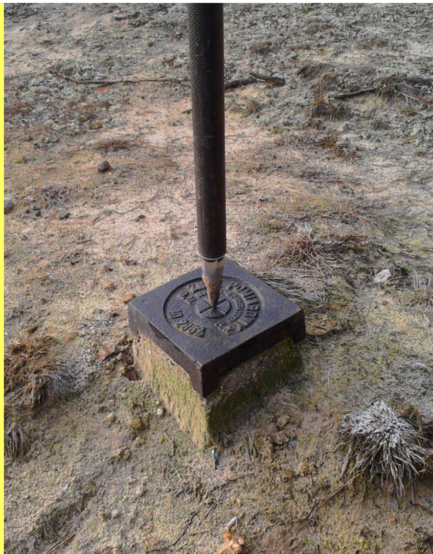
Rys. 13. Punkt osnowy III klasy nr 12G wykorzystany do pomiaru i transformacji do układu „1965” (foto. autora)
